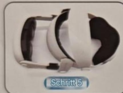
Richten Sie beide Seiten aus und setzen Sie sie ein. Drücken Sie nach dem Einsetzen beide Seiten langsam und kräftig in die gleiche Position und richten Sie sie aus.
